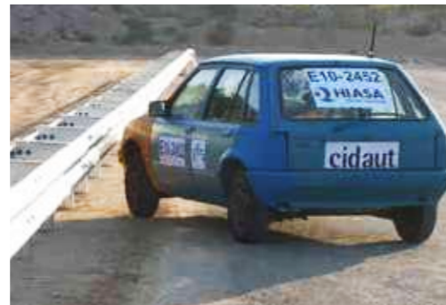
▲ TB11-botsproef: bepaling schokindex.
