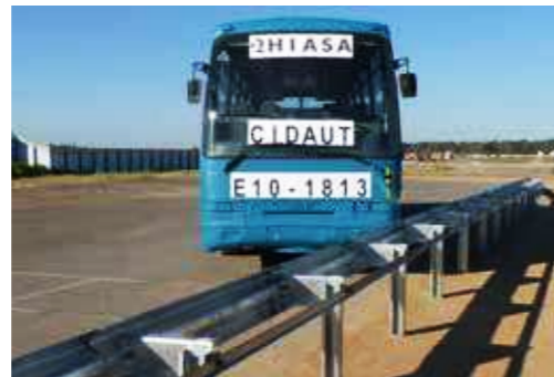
▲ TB51-botsproef: bepaling 'kerend vermogen'.
