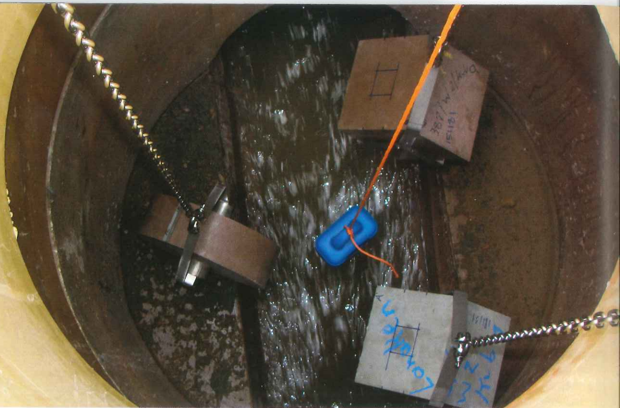
Afbeelding 1: Te monitoren stalen, opgehangen net boven de waterlijn.
