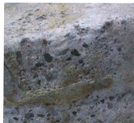
Afbeelding 3: Gellik: ZVB-kubus na 1 jaar blootstelling.
