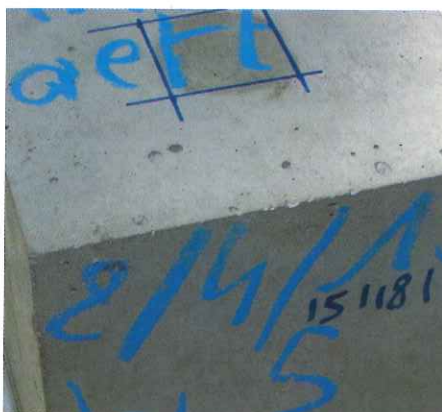
Afbeelding 2: Gellik: ZVB-kubus voor blootstelling.
