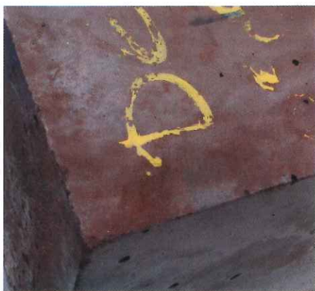
Afbeelding 5: Gellik: zwavelbeton na 1 jaar blootstelling.
