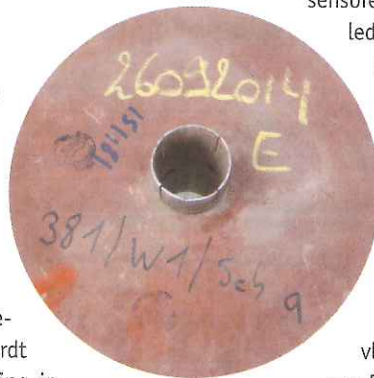
Afbeelding 6: Zwavelbetonnen TAP-schijf in Gellik.
