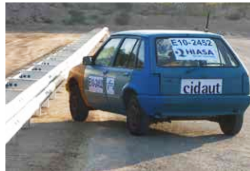
▲ TB11-botsproef: bepaling schokindex.
