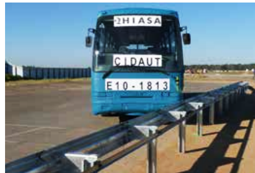
▲ TB51-botsproef: bepaling 'kerend vermogen'.
