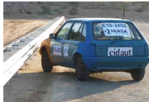
▲ Essai de Choc TB11 : détermination indice de choc.
