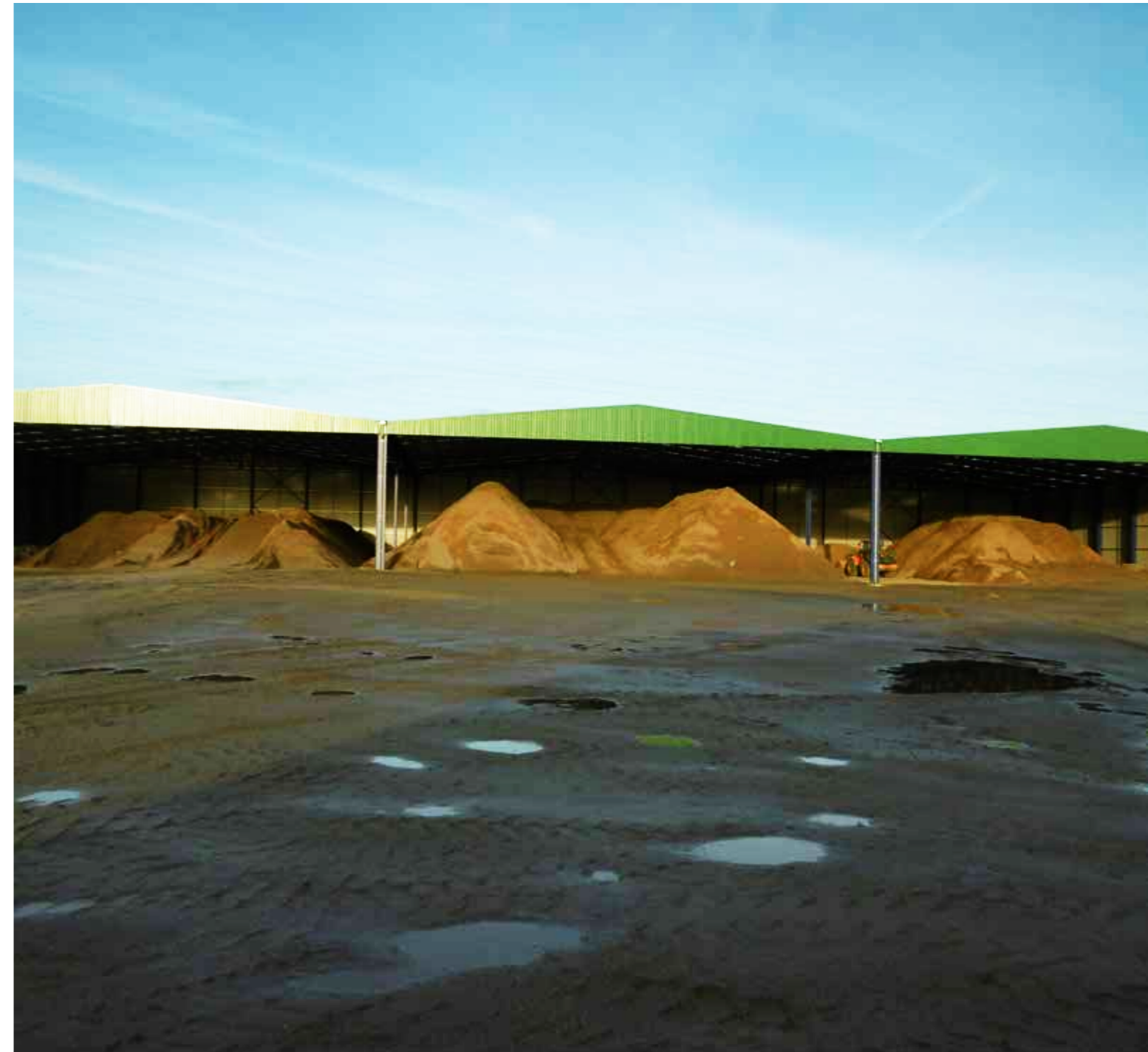
▲ Dépôts de sable FeMo pour utilisation en asphalte.
