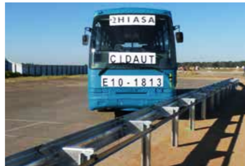
▲ Essai de Choc TB51 : détermination niveau de retenue.
