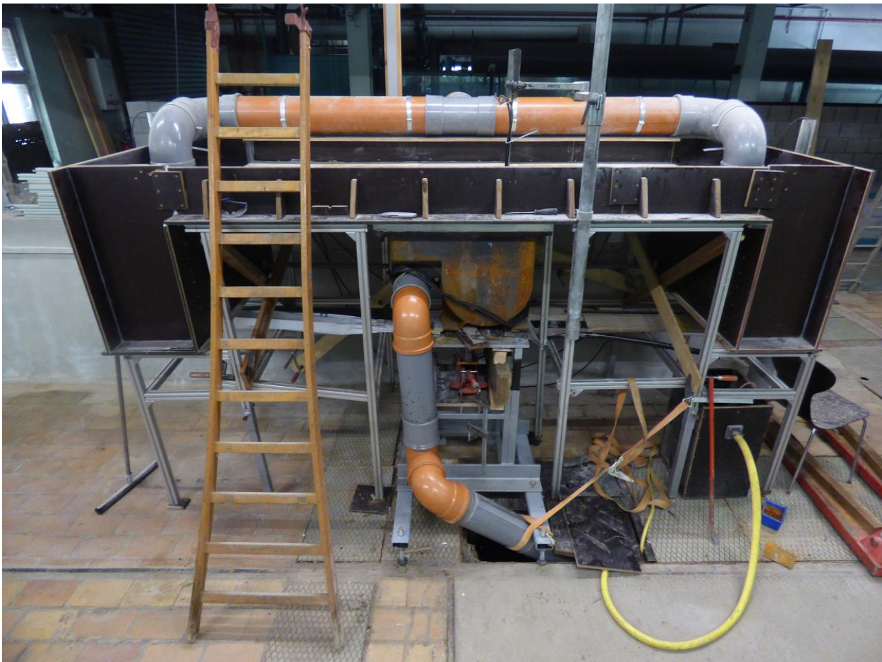
Foto 1 – Vooraanzicht van de proefopstelling (gietijzeren kolk).
